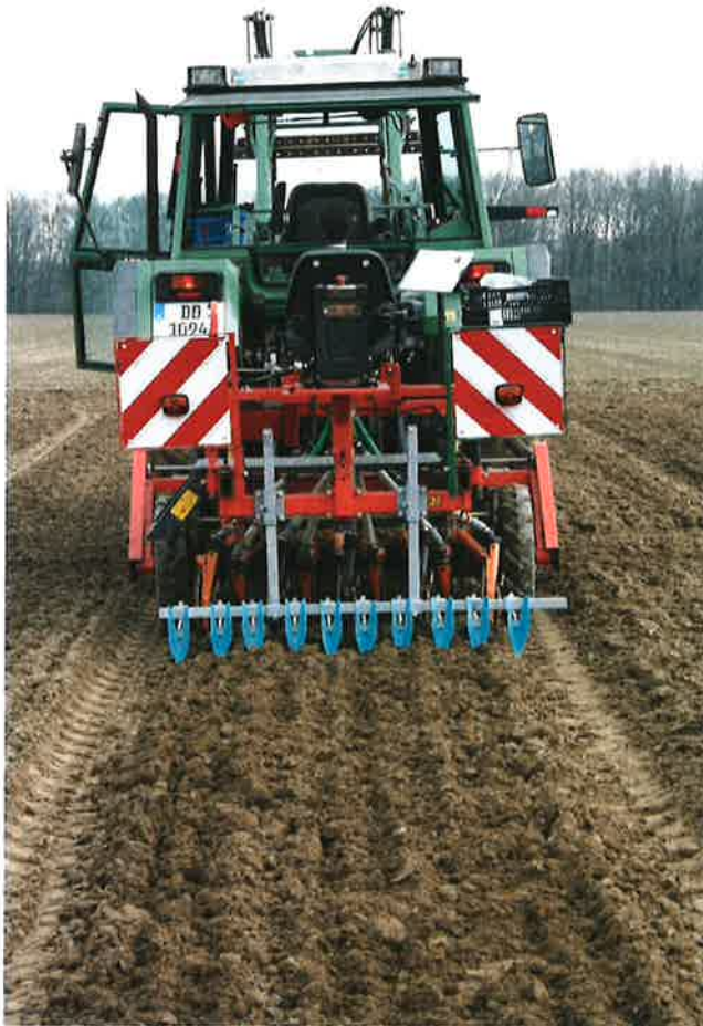
Abb. 1: Traktor mit angebauter Parzellendrillmaschine und Dammformer (Klappendorf, 04.04.2016)
